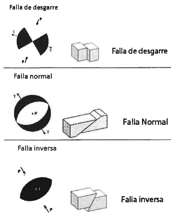
Figura 10. Ejemplos gráficos de fallas típicas y su representación sobre la esfera focal.
